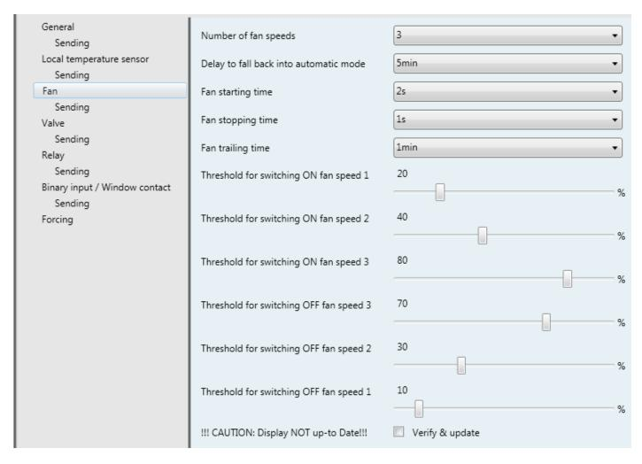
Figure 9: Fan parameters
