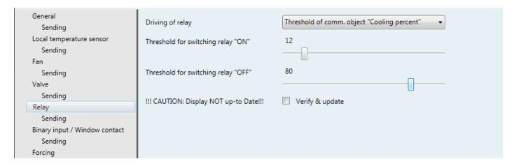
Figure 15: Relay parameters
