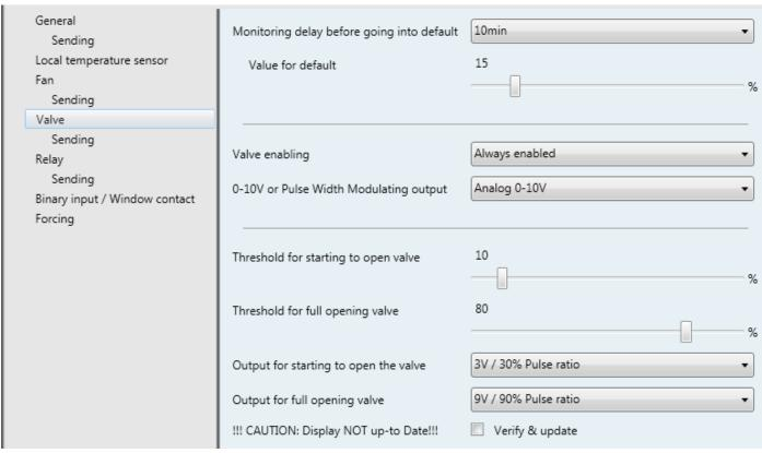
Figure 12: Valve parameters
